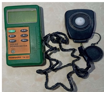
Fig. 4 solar power meter
